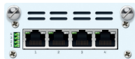
4 puertos de 1 GE de cobre PoE [Para SG/XG 210 Rev. 3 y SG/XG 230, 3xx y 4xx Rev. 2 solamente]
